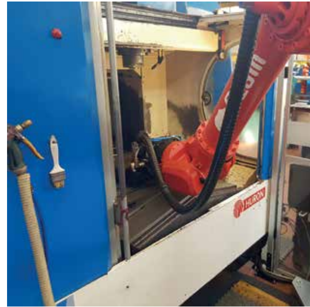
Le Huron a 3 e 5 assi, già presenti in officina, lavorano l'una di fronte all'altra, mentre un robot antropomorfo da 350 kg di portata si incarica dei movimenti a tutto tondo
